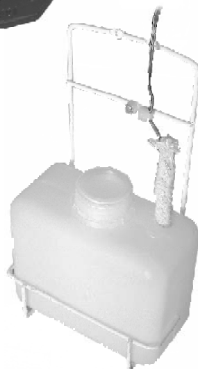
Montagem com sensor de bulbo úmido (pavio)*
